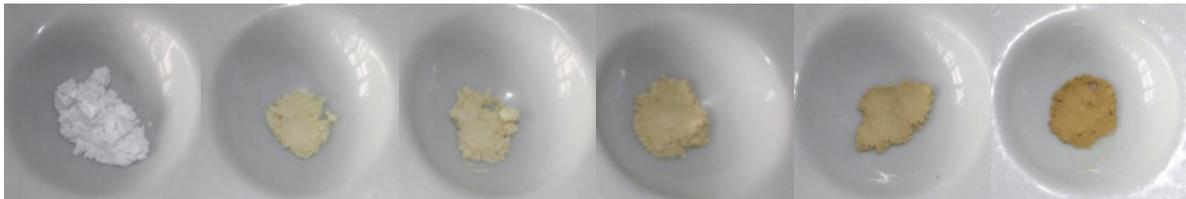
**Abbildung 8.5** Fotografien der Gleichgewichtsbodenkörper für den Farbvergleich. Von links nach rechts:  $\text{TiP}_2\text{O}_7$ , Experiment Ti1, Ti2, Ti3, Ti4, und Ti5.
