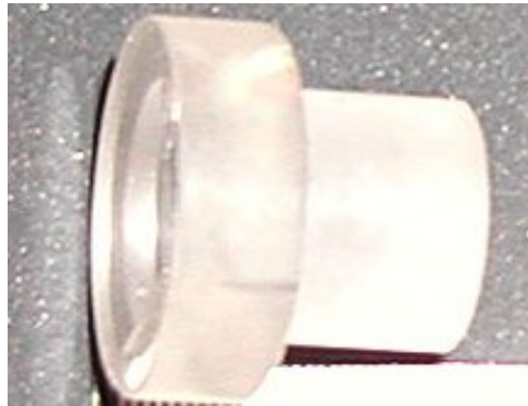
Abbildung 3.2: Seitenansicht eines gestuften Saphirfensters zur Reduktion der optischen Weglänge in den selbstkonstruierten Zellen.
