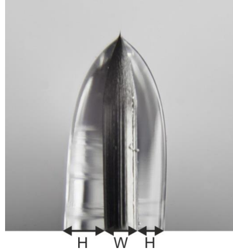
Abb. 4.7: Mit Heißkleber (H) isolierte STM-Spitze aus Wolfram (W) [Lit. 54].
