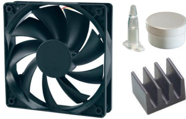
Abbildung 5.8: Komponenten des Kühlungssystemkonzepts. Es wird als aktive Kühlung ein Lüfter (links) und als passive Kühlelemente Miniatur-Kühlkörper (rechts unten) verwendet, die mit Zweikomponentenkleber (rechts oben) auf die Front-End-Chips geklebt werden sollen.
