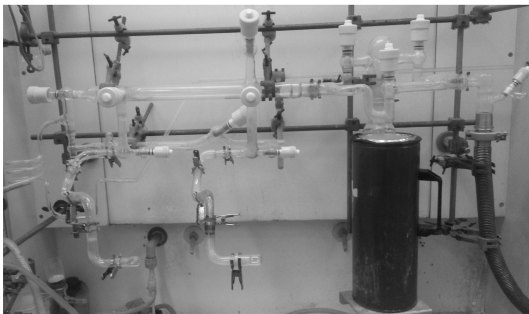
Abb. 2.1: Vollglas-Vakuum-Schutzgas-Apparatur mit PTFE-Hähnen.
