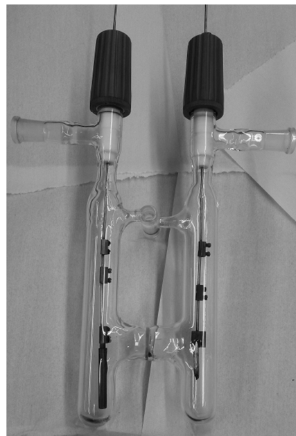
Abb. 2.4: Elektrolysezelle mit PTFE-Hähnen.
