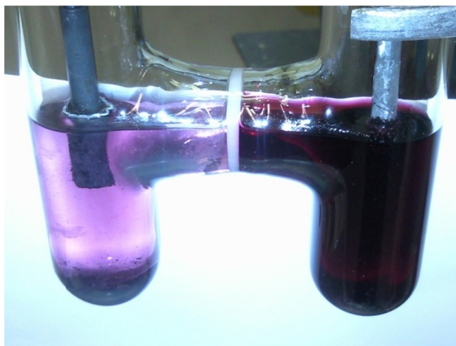
Abb. 3.1: Elektrolyse von Tellur mit \text{Na}(\text{AsF}_6) als Leitsalz in flüssigem \text{SO}_2 nach einigen Tagen.
