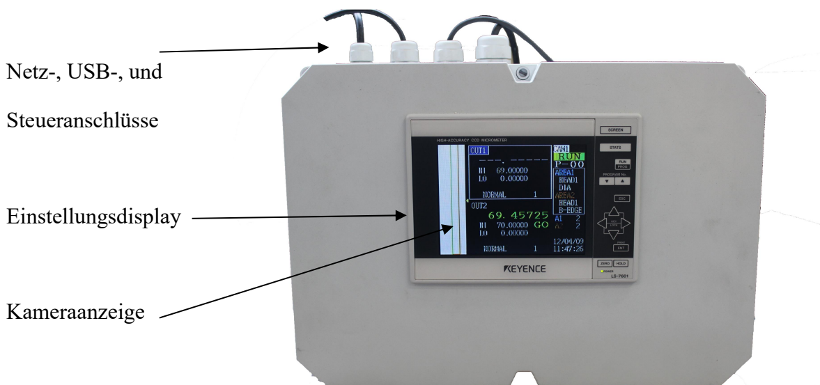
Abbildung 14: Steuerungsbox zur Einstellung der Sensorik und Aufnahme von Messdaten
