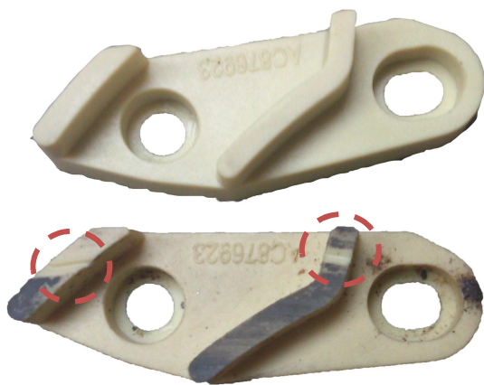
Abbildung 64: Durch umgedrehten Einbau der Lochsäscheibe verursachter Schaden am Zwangsabstreifer, Sägerät 1, oben: neuer Abstreifer, unten: beschädigter Abstreifer
