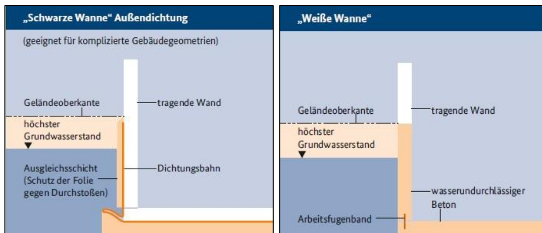
Abbildung 14: Gegenüberstellung der Gebäudeabdichtungstypen „Schwarze Wanne“ und „Weiße Wanne“ (Quelle: BMUB (2015) 216 , nach DIN 18195 217 , DIN 1045 218 und DIN EN 206 219 )
