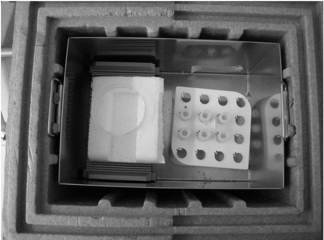
**Abb. 10:** Versuchsaufbau in der Ansicht von oben: In die Styropor-Kiste wurde eine passende Metallkiste gestellt. Diese enthält einen Plastikständer für die Reaktionsgefäße sowie einen Metallständer. Der Metallständer wurde mit einer Styroporplatte und einer IVF-Schale versehen, um die Proben zunächst langsam einfrieren zu lassen, bevor sie in die Reaktionsgefäße überführt wurden. Der Stickstoff-Füllstand wurde mit Hilfe einer Markierung durch ein Klebeband angezeigt.
