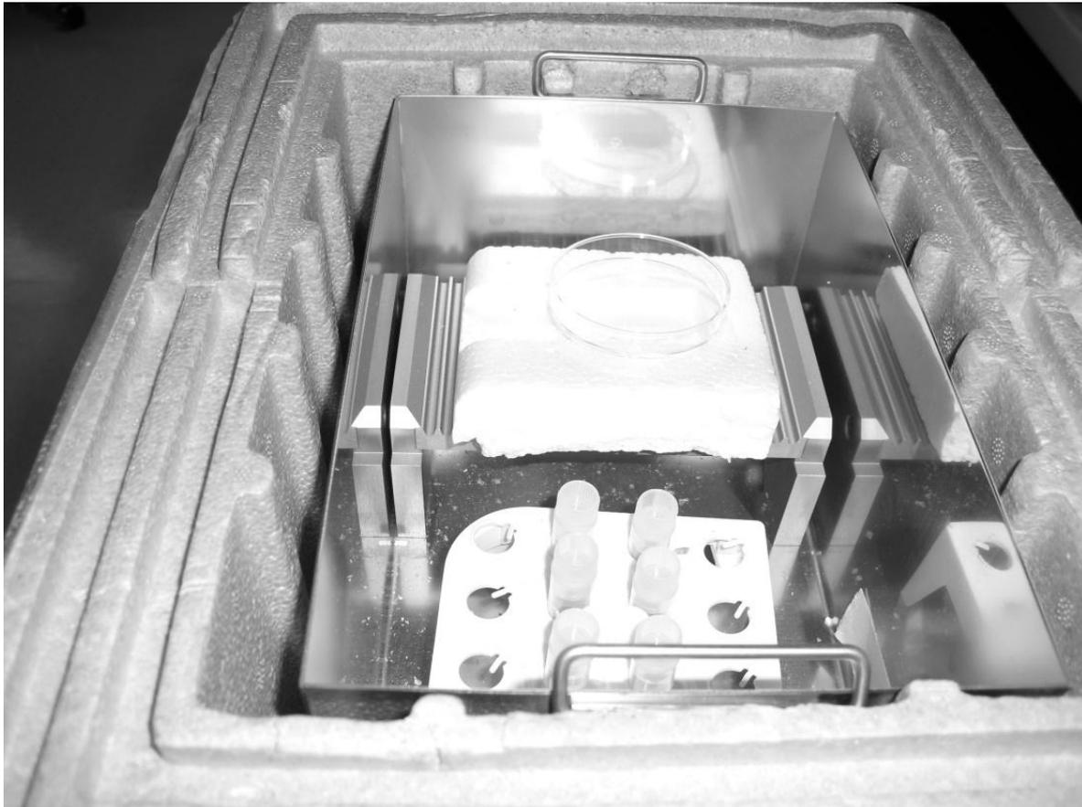
**Abb. 11:** Versuchsaufbau in der Ansicht von der Seite: Die Abbildung zeigt alle relevanten Bestandteile des Versuchsaufbaus. Die Dicke der Styroporplatte auf dem Metallständer reguliert die Geschwindigkeit des Einfrierens der Probe in der IVF-Schale, bevor sie in eins der Reaktionsgefäße überführt wird. Auch der Stickstoffstand in der Metallkiste kann den Einfriervorgang je nach Höhe beschleunigen oder verlangsamen. Er wird durch eine Markierung konstant gehalten.
