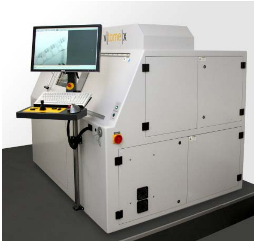
Abb. 16: Mikrofokus Computertomograph V/tome/x s 240D (Fa. GE Sensing & Inspecting Technologies – phoenix/x-ray) betrieben von der Firma Freudenberg Forschungsdienste SE & Co. KG in Weinheim betrieben
