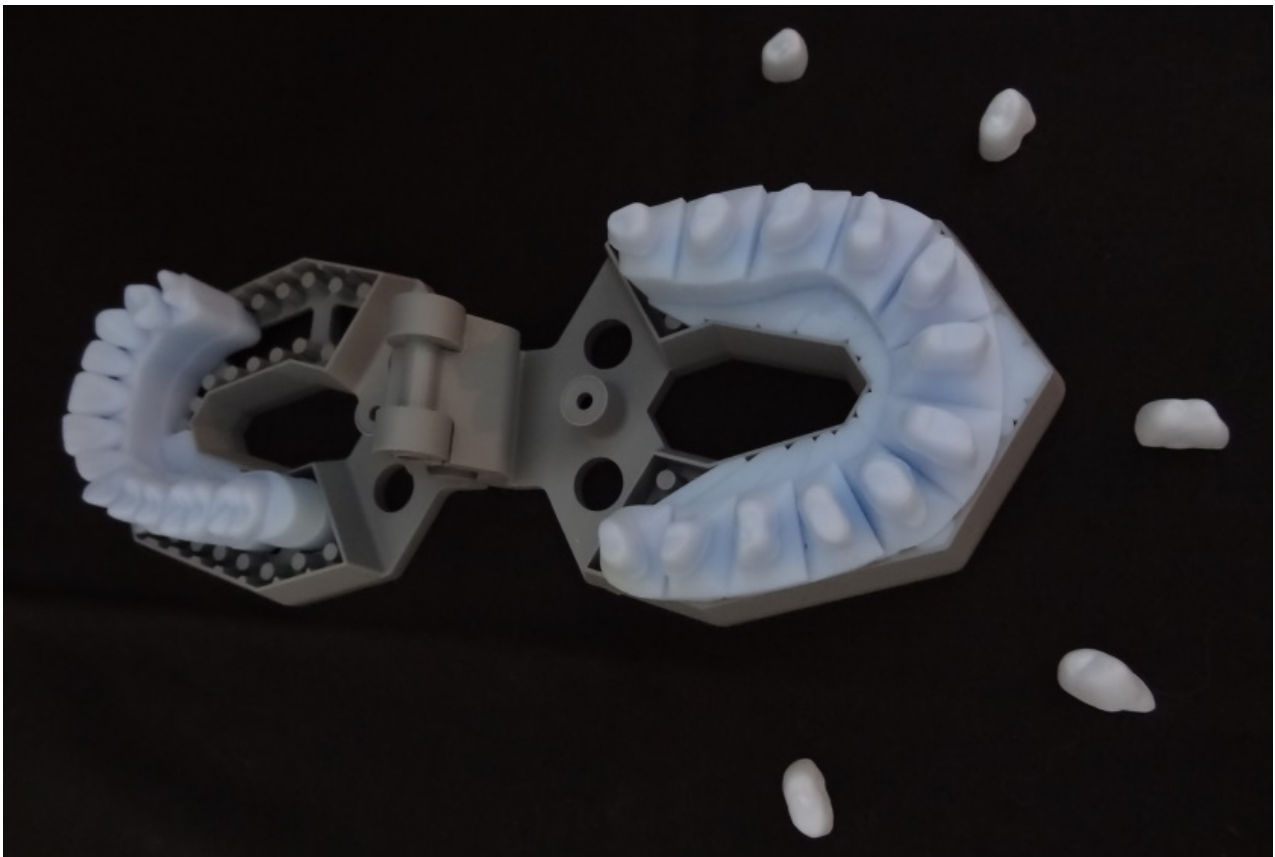
Abb. 8: Stereolithographisches Modell mit LAVA™-Zirkonoxidkappchen
