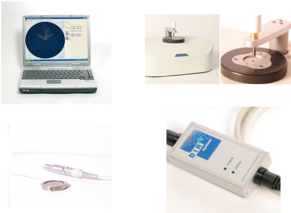
Abb. 12: Komponenten des DIR®-Systems: oben links: Computer; oben rechts: Kreuzmesstisch; unten links: Sensor, unten rechts: Messverstärker; DIR®-System® GmbH & Co. KG und Fundamental Schulungszentrum in Essen mit freundlicher Genehmigung.
