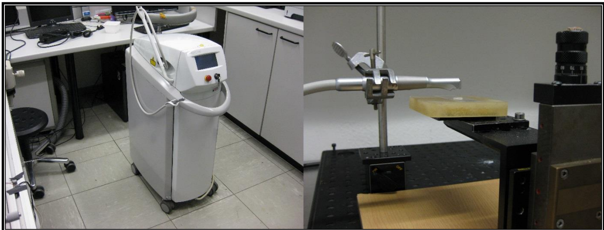
Abb. 2: Links: Er:YAG-Laser von Typ Kavo Key III. Rechts: Nonkontakt-Handstück 2060 des Kavo Key III Lasers positioniert über dem Probenhalter. Im Vordergrund ist die Mikrometerschraube zur Einstellung des Abstands zwischen Proben und Austrittsfenster des Handstücks zu sehen.
