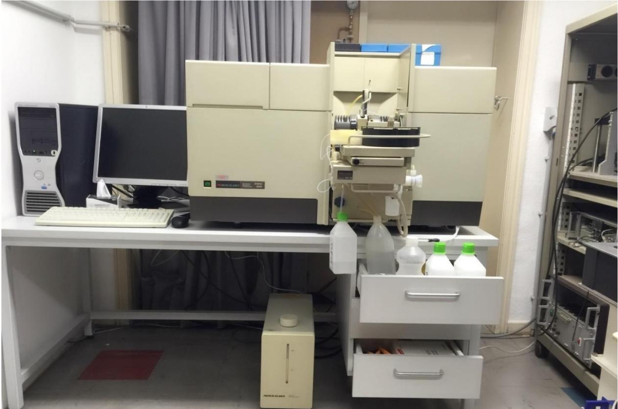
**Abbildung 11:** Atomabsorptionsspektrometer zur quantitativen Analyse von Elementen (Metalle, Halbmetalle) in wässrigen Lösungen.
