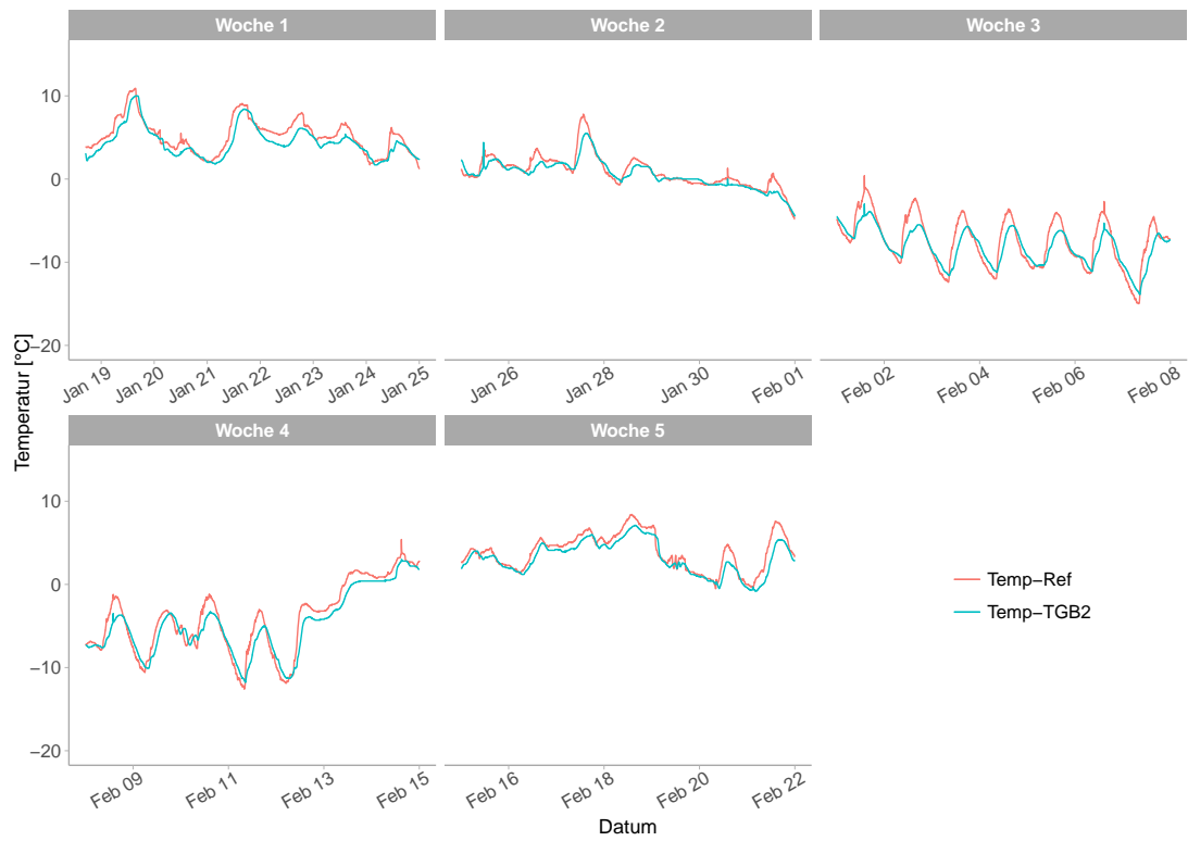
Abbildung B.8.: Temperaturentwicklung in TGB 2.2 und Umgebung im praktischen Versuch zur Kaltlufttrocknung; Versuchsdurchgang 2 vom 18.01.2012 bis 21.02.2012, Campus Klein-Altendorf
