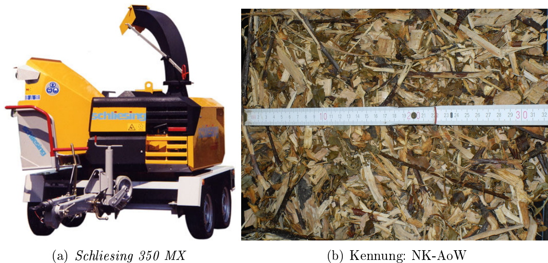
Abbildung 4.5.: Mobiler Scheibenradhacker angetrieben durch Dieselaggregat (a) sowie Holzhackschnittel aus Rodungsholz ohne Wurzelanteil; Holzart: Apfel; Korngrößenklasse: nicht klassifiziert (b)
