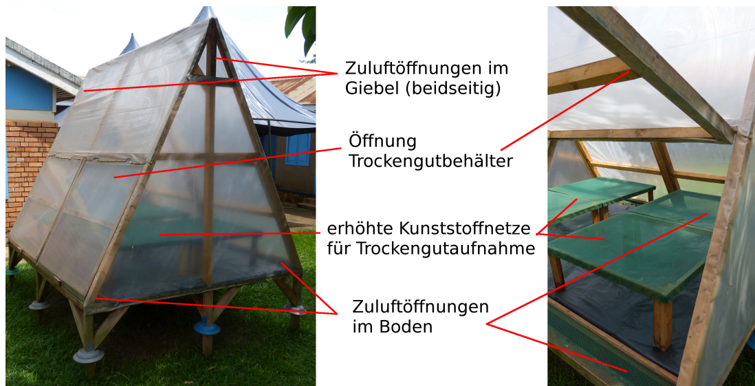
Abbildung 2.10.: Direkter Solartrockner ohne künstliche Belüftung nutzt Venturieffekt für Luftwechsel; Standort: Revelation Life, Kampala, Uganda; Januar 2016
