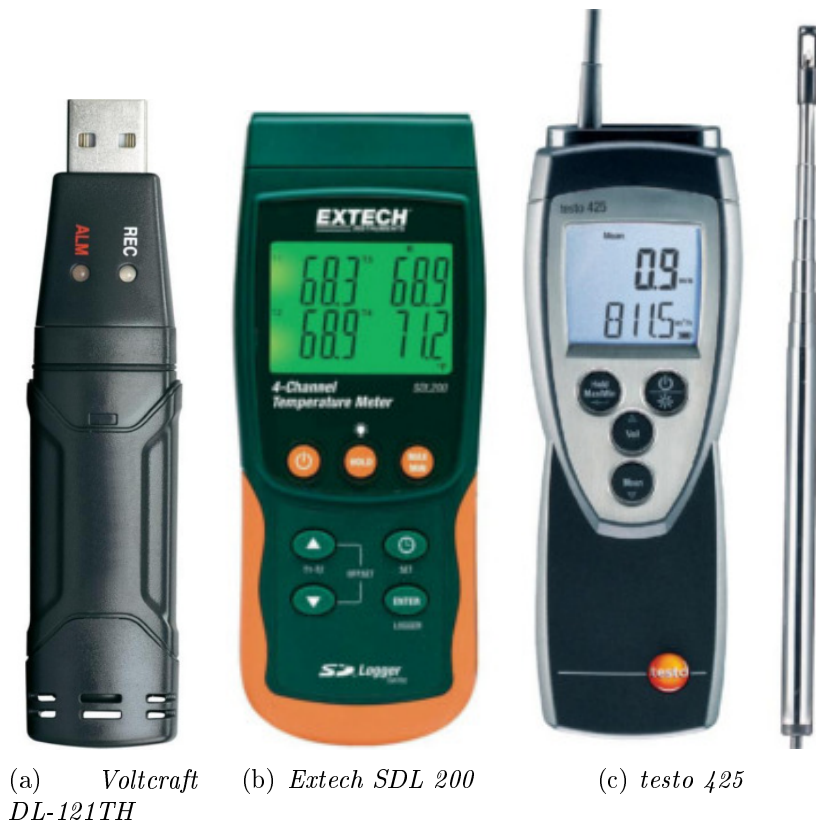
Abbildung 4.6.: Verwendete Handmessgeräte zur Messung und Speicherung von Temperatur-, Luftfeuchte- und Luftgeschwindigkeitswerten; Bildquellen: (a) [ANONYMUS13, 2016], (b) [ANONYMUS14, 2016], (c) [ANONYMUS15, 2016]
