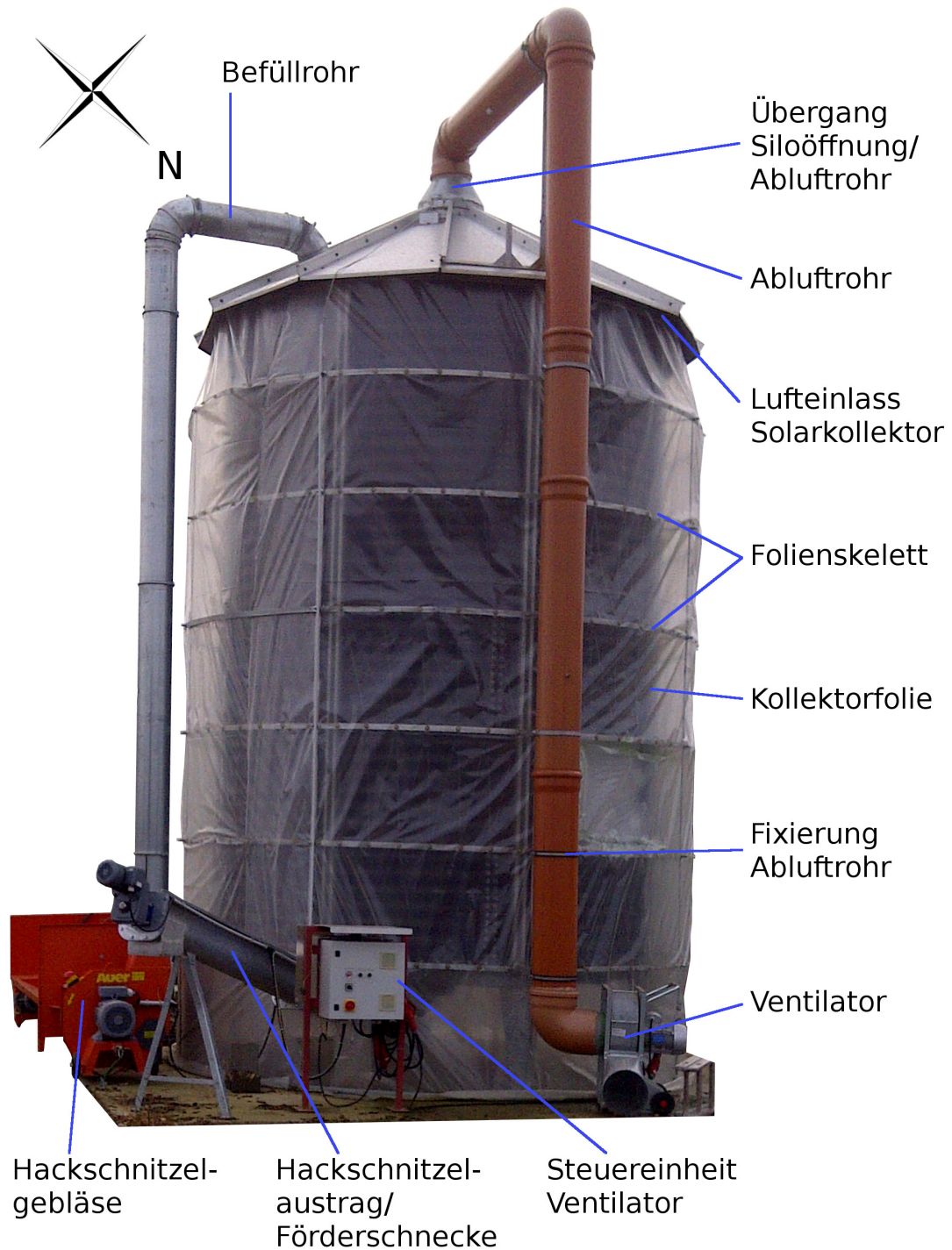
Abbildung 8.7.: Darstellung des solaren Satzrockners nach Beendigung der Konstruktionsarbeiten; Standort: Campus Klein-Altendorf; März 2012
