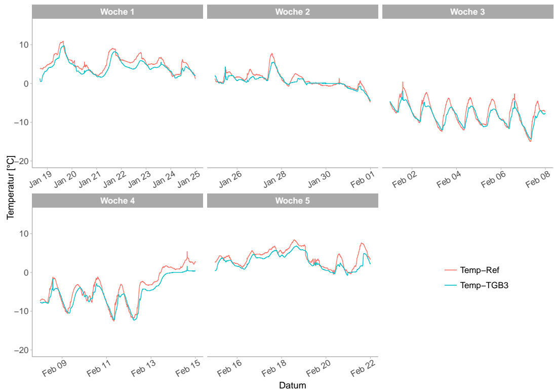
Abbildung B.9.: Temperaturentwicklung in TGB 2.3 und Umgebung im praktischen Versuch zur Kaltlufttrocknung; Versuchsdurchgang 2 vom 18.01.2012 bis 21.02.2012, Campus Klein-Altendorf
