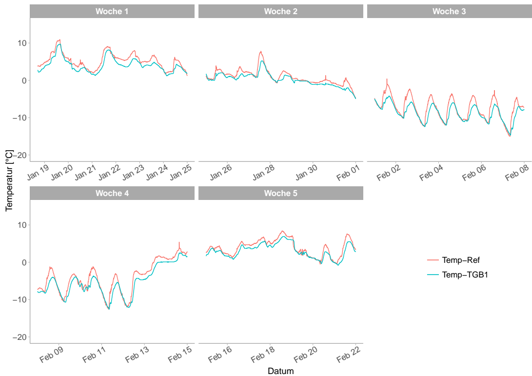
Abbildung B.7.: Temperaturentwicklung in TGB 2.1 und Umgebung im praktischen Versuch zur Kaltlufttrocknung; Versuchsdurchgang 2 vom 18.01.2012 bis 21.02.2012, Campus Klein-Altendorf
