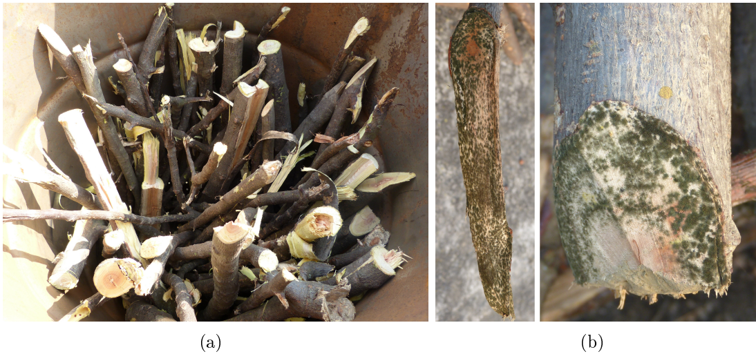
Abbildung 9.23.: Das Aufgabegut im Trockner (a) zeigt keine Schimmelspuren, während das im freien gelagerte Holz (b) nach 14 Tagen Testzeit bereits grünliche Verfärbungen aufwies. Standort: Gulariya, Bardiya; Tag 14: 09.12.2014
