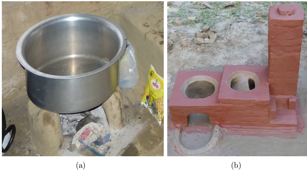
Abbildung 9.1.: Traditionelle Kochstelle (a) und verbesserter Herd (b) als Variante mit einem Verbrennungsraum für zwei Kochtöpfe und Kamin
