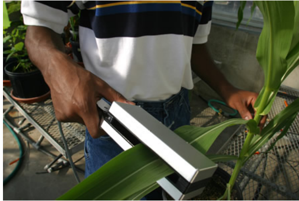
Abbildung 2.3 Darstellung eines Leafmeters der Firma Li-Cor zur Messung der Blattfläche, das im Aufbau und Funktion dem benutzen Leafmeter ähnelt. Das Leafmeter wird über das zu messende Blatt bewegt, dabei wird die Geschwindigkeit und die Breite des Blattes gemessen, beides zusammen ergibt ein Maß für die Größe des Blattes. Abbildung aus [Li-Cos INC., 2015]
