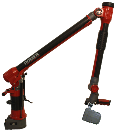
Abbildung 1.1: Nahbereichslaserscanningsystem bestehend aus ROMER Infinite 2.0 Messarm und Perceptron ScanWorks-V5 Laserlinienscanner
