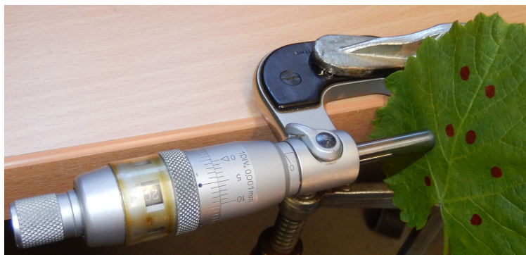
Abbildung 6.3: Erzeugung von Vergleichswerten für die Blattdicke mit einem Bügelmikrometer. Die roten Punkte markieren die gewählten Messstellen.
