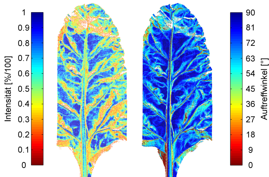
Abbildung 5.17: Punktwolke eines Rübenblattes eingefärbt mit der Intensität ( links ) und mit dem Auftreffwinkels des Lasers ( rechts ).
