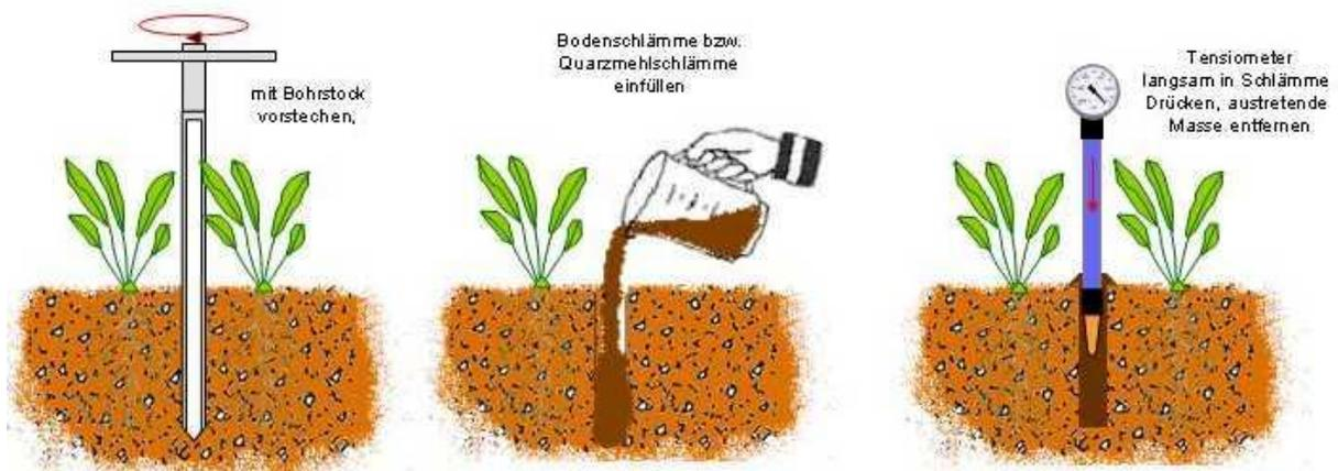
Abb. 17: Installation eines Tensiometers; links: Installationsloch mit Bohrstock ausstechen; mitte: Einfüllen von Bodenschlämme; rechts: langsames Einführen des Tensiometers
