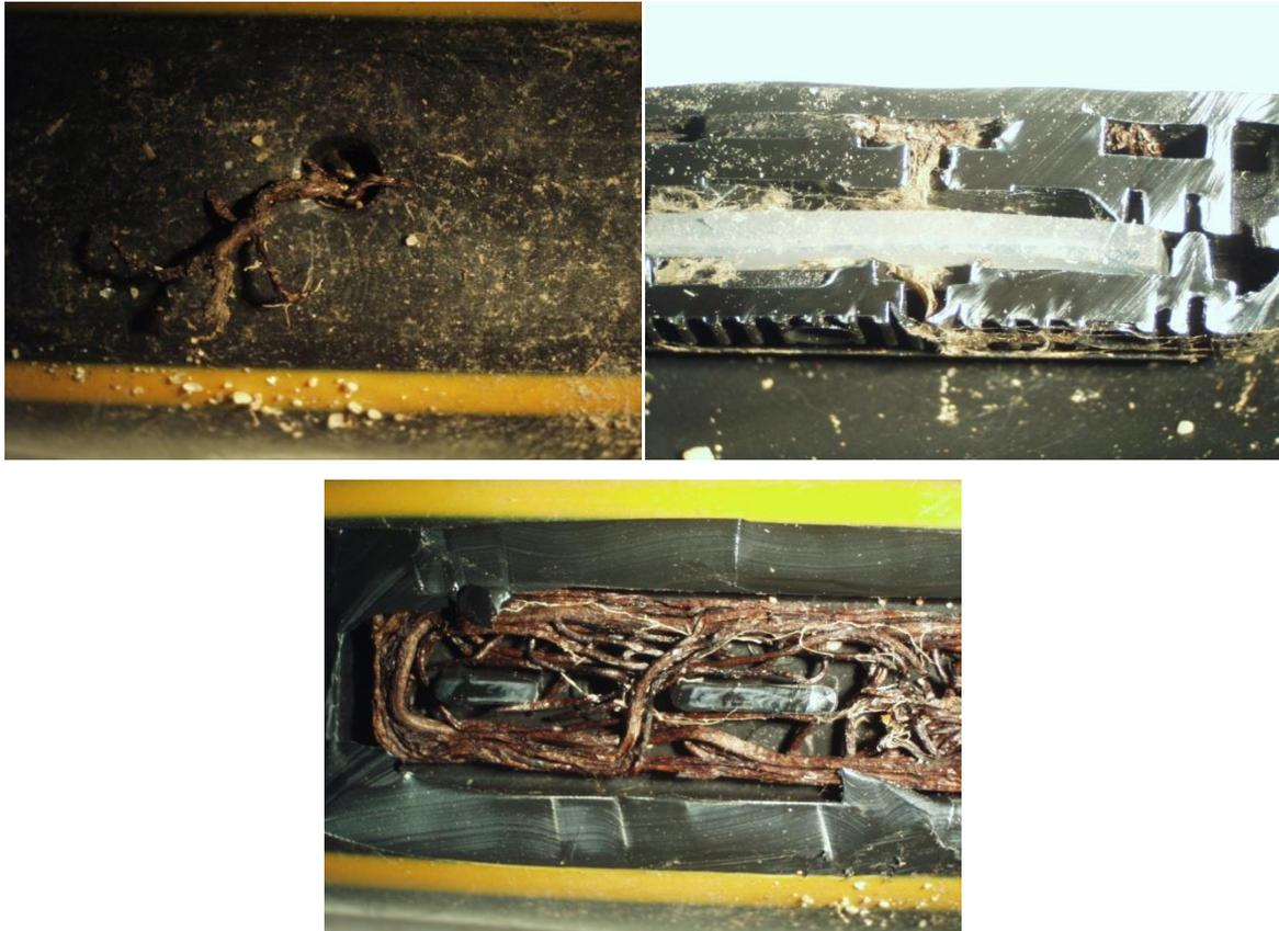
Abb. 42: Quer- und Längsschnitt vom Tropfer mit Wurzelbarriere im Weinbauversuch, Portugal (Netafim UniRam AS); links oben: Eintritt der Wein-Wurzel in das Tropfloch; oben rechts: Längsschnitt des Tropfers; Mitte unten: Vorkammer mit Einwuchssperre (Quelle: João Azevedo, 2013)
