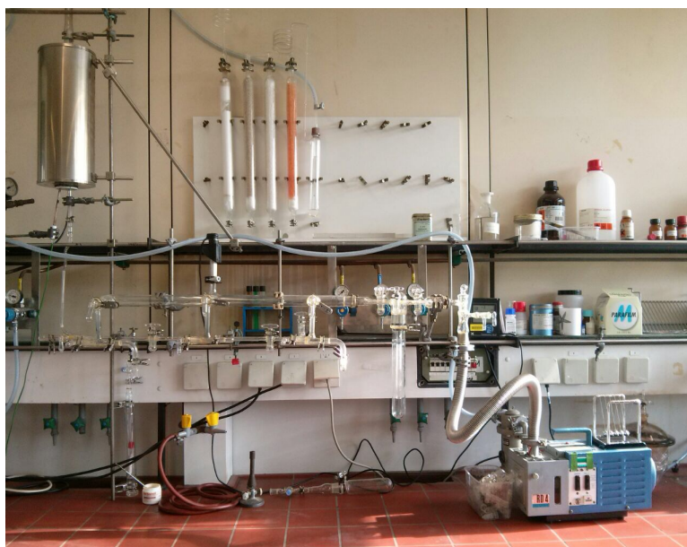
Abbildung 7.1.1.1: Vakuum-Intergas-Linie (unten mittig) mit Drehschieberpumpe (unten rechts) und Titanofen (oben links).
