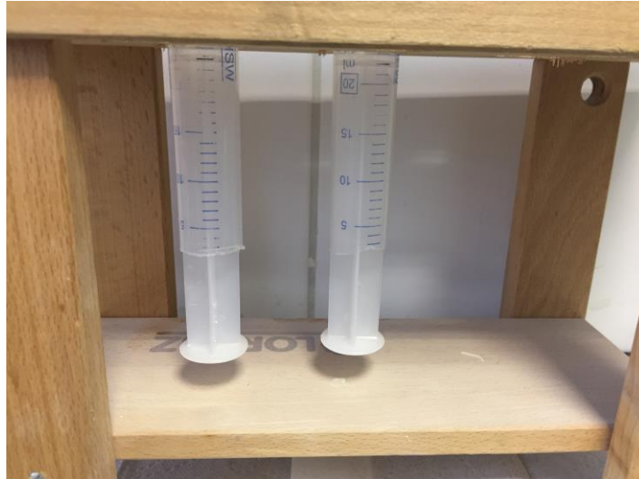
Abb. 7: Hergestellte Holzvorrichtung zum Einhängen der Einmalspritzen
