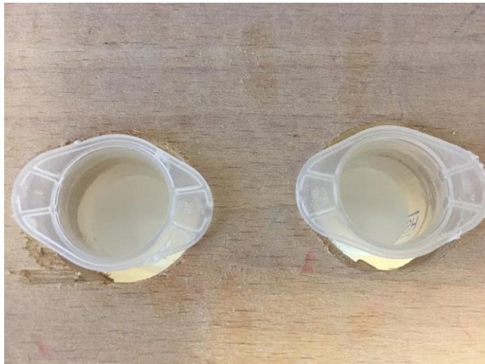
Abb. 8: Unbefüllte Einmalspritzen in der Holzvorrichtung
