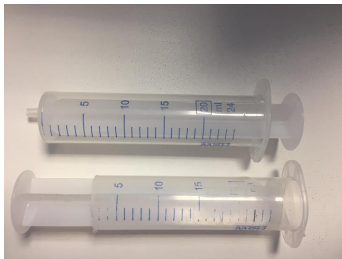
Abb. 6: Modifizierte Einmalspritze ohne Düse im Vergleich zur unbehandelten Einmalspritze
