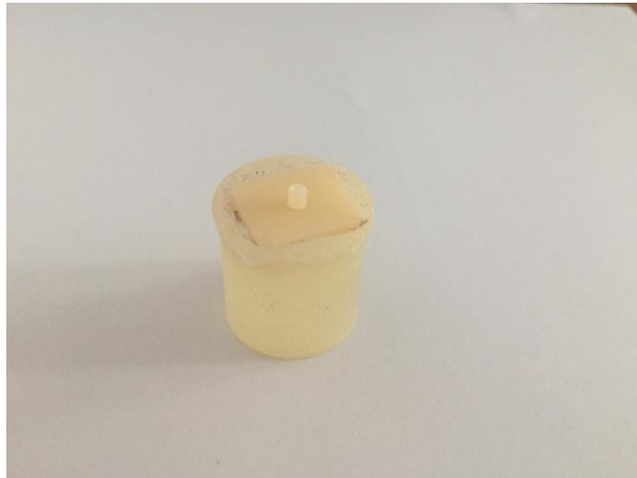
Abb. 14: Fertiger Probenkörper mit aufgeklebtem Kompositknöpfchen
