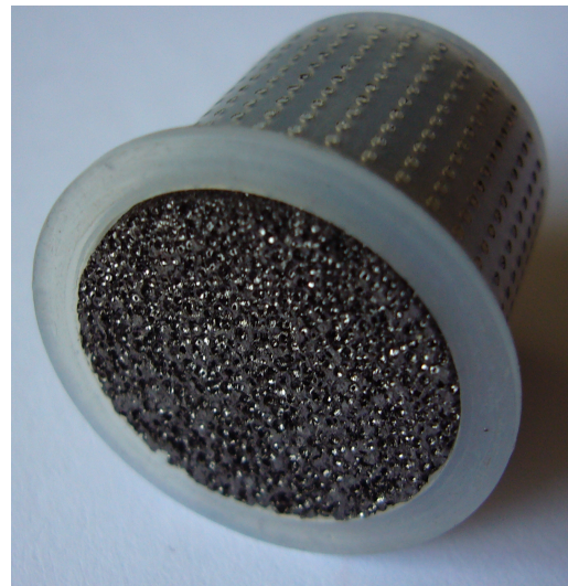
Abb. 3.19.: Foto der mit Kohlenstoffschaum gefüllten Targetzelle. [Grü15]
