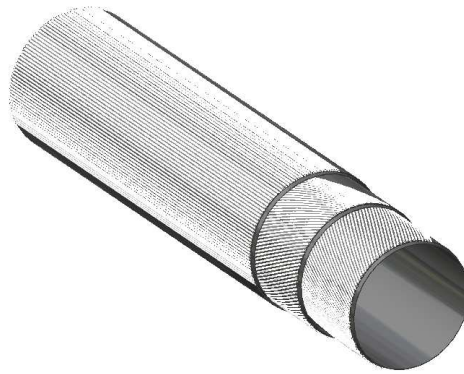
Abb. 3.30.: Dreilagige Anordnung der Fasern im Innendetektor. [CB16b]
