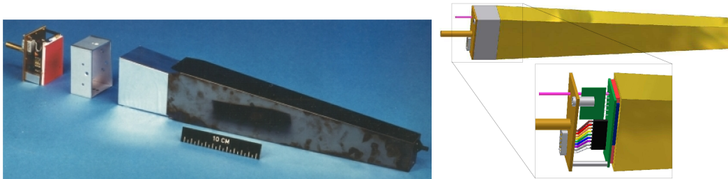
Abb. 3.25.: CsI(Tl)-Kristall des Crystal-Barrel-Kalorimeters. Auf der linken Seite ist ein Foto, auf der rechten Seite eine CAD-Zeichnung zu sehen. Auf letzterer ist die Ausleseelektronik mit Photodiode (blau) und Wellenlängenschieber (rot) vergrößert dargestellt. [CB16b]
