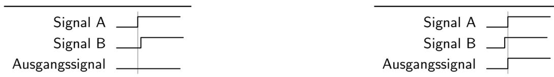
Abbildung 3.6.: **Darstellung der Auswirkung von leicht wechselnden Signallaufzeiten bei asynchronen Logiken.** Die hier zugrundeliegende Schaltung überprüft beim Anstieg vom asynchronen Signal A das Signal B. Auf der linken Seite kommt dabei das Signal B kurz nach dem Signal A. Daher wird kein Ausgangssignal ausgegeben. Auf der rechten Seite kommt das Signal B kurz vor dem Signal A. Daher wird ein Ausgangssignal gesendet.
