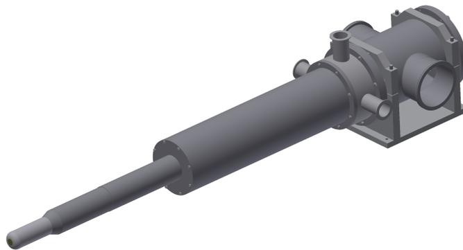
Abbildung 2.7.: **Darstellung des Bonn-Frozen-Spin-Targets.** Gezeigt ist der Kryostat des Targets mit der Targetzelle am linken Ende [Wal18].
