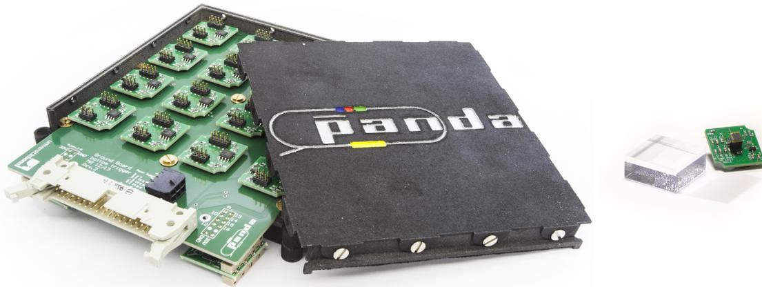
Abbildung 3.4: Links: Ansicht des geöffneten Triggerdetektors mit der Grundplatine und den darauf gesteckten Vorverstärkerplatinen, welche auch die Wandlung des SiPM-Signals in ein differentielles Signalformat übernehmen. Auf der Vorderseite des Detektors sind die Spannungsteilerplatinen zur Einstellung der individuellen Betriebsspannung der SiPMs zu erkennen. Rechts: Einzelner Szintillator ohne reflektierende Folie und Vorverstärkerplatine mit aufgestecktem SiPM.
