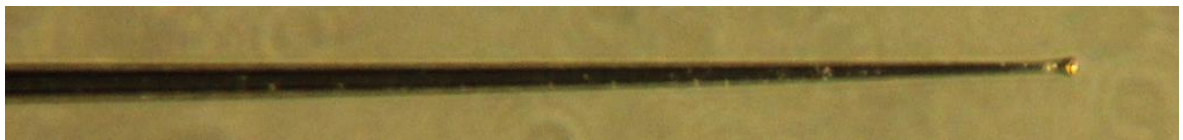
Abb. 7: Letvin Elektrode mit einer mit Gold und Platin beschichteten Spitze. Der Durchmesser der Spitze beträgt ca. 2 \mu\text{m}
