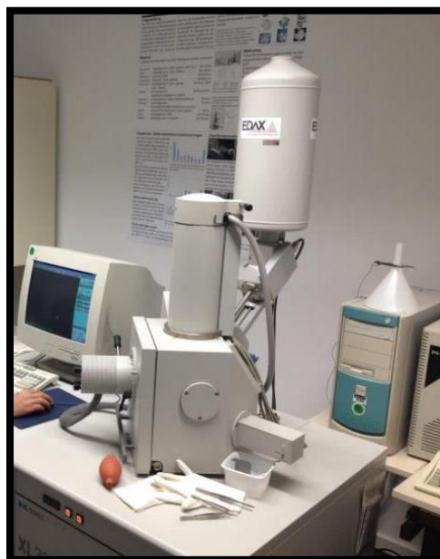
Abb. 16: Rasterelektronenmikroskop mit Steuereinheit und Rechner.
