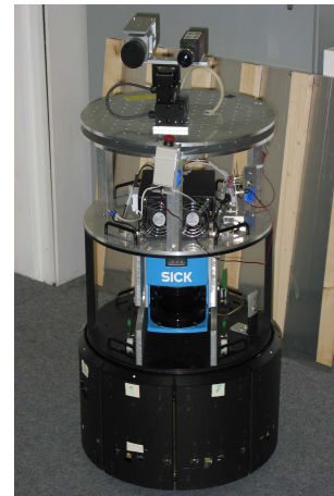
Abbildung 9.1: Ein B21-Roboter mit den Laserscannern und dem Kamerasystem (oberer Bereich). Die linke Kamera ist die Wärmekamera.
