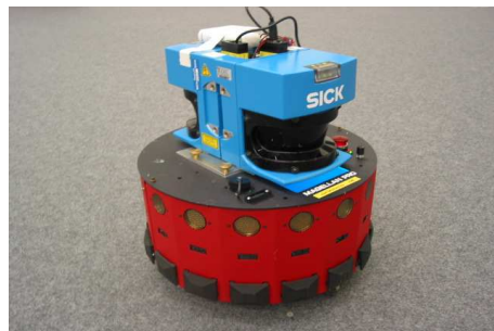
Abbildung 4.1: Zwei SICK Laserscanner Rücken an Rücken montiert an einem Roboter.
