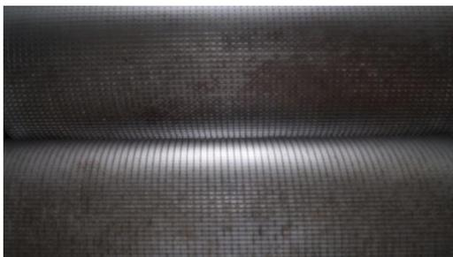
Abb. 5: Die Shredlage-Crackerwalzen mit dem groben Sägezahnprofil und der umlaufenden Spiralnute bewirken eine intensive Aufbereitung des Materials. Foto: J. Denißen
