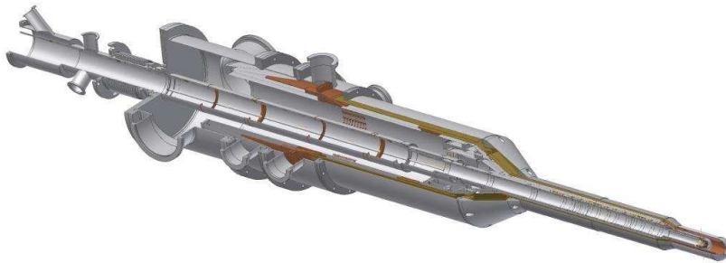
Abbildung 2.9.: Bonn-Frozen-Spin-Target mit Kryostat. [Wal09]
