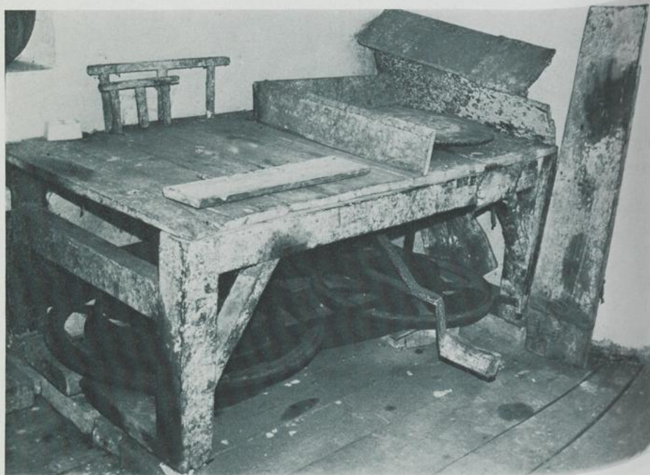
Abb. 73 Kontinuierlicher Drehvorgang auf einer Tretscheibe mit Übertragung (Riemenscheibe), Niersbach, 2. Viertel 20. Jh. Abb. 74 Riemenscheibe, Niersbach 1975
