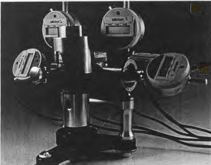
Abbildung 2: Meßartikulator mit eingesetztem Justierblock und aufgelegtem Gewicht
