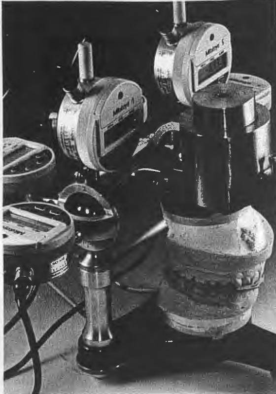
Abbildung 3: Messungsbeispiel mit korrigiertem Wachplattenregistrat und aufgelegtem Gewicht
