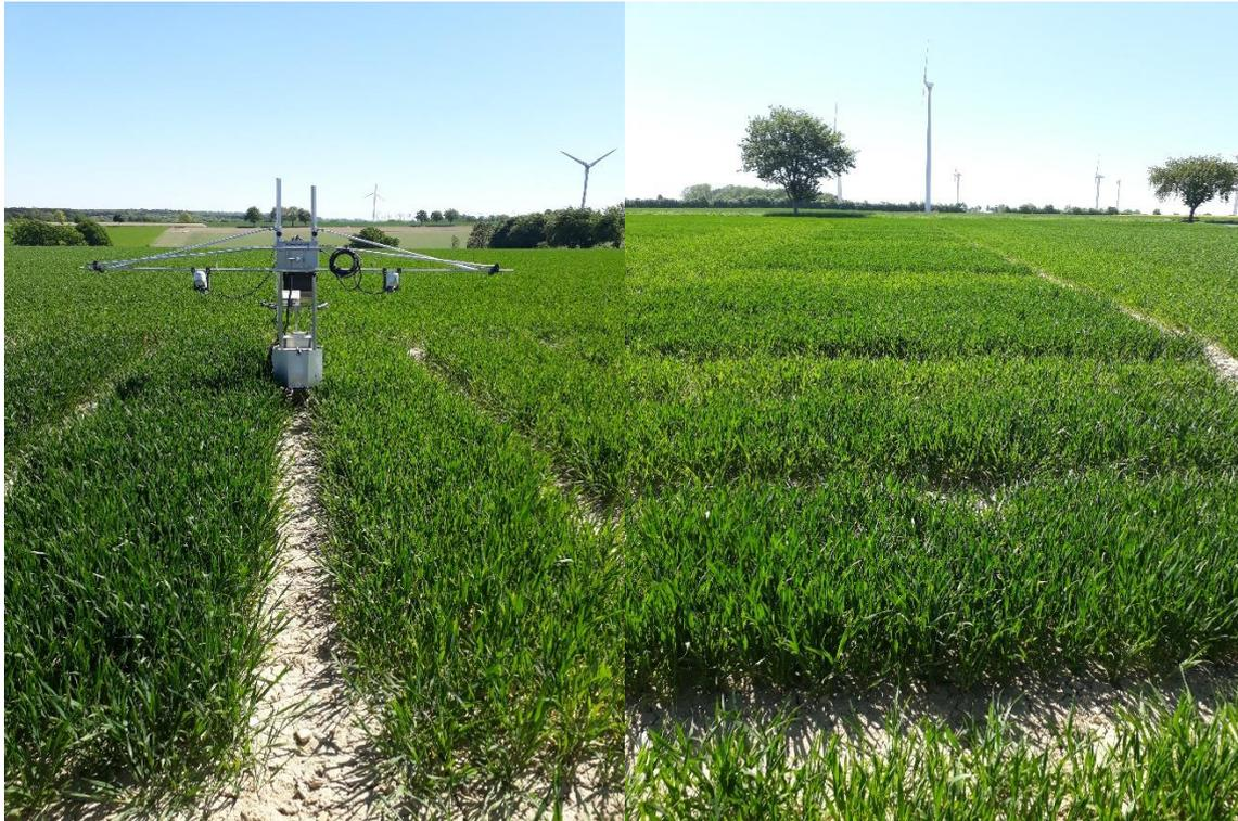
*Abbildung 10: GreenSeeker®-Einsatz (links) und sichtbare N-Düngestufen innerhalb der Parzellen (rechts). Beide Aufnahmen nach Vorfrucht Erbse am Standort Haarstrang.*
