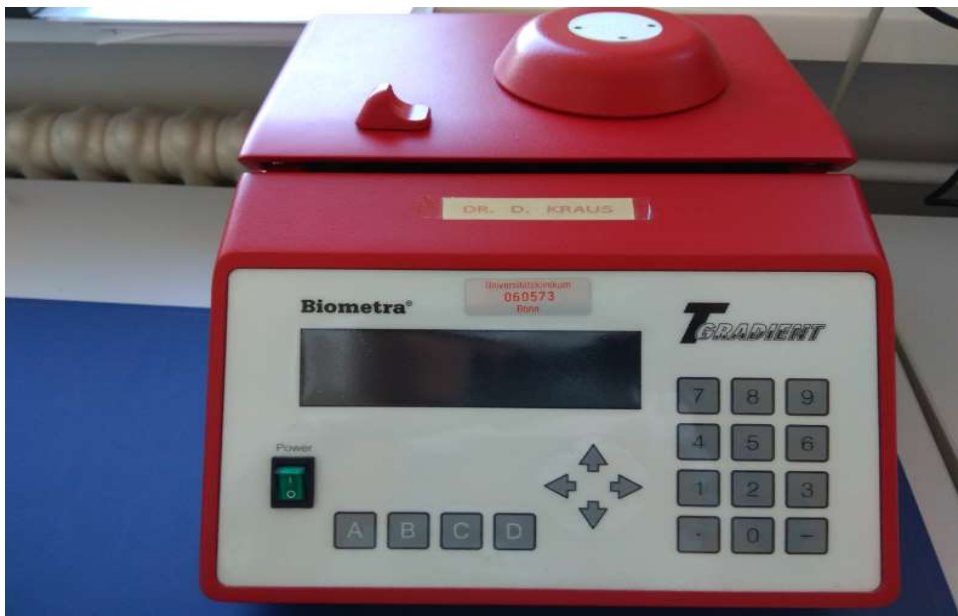
Abb. 6: Thermocycler (TGradient) für die standardisierte Wärmebelastung von Mikroorganismen und Zellen.
