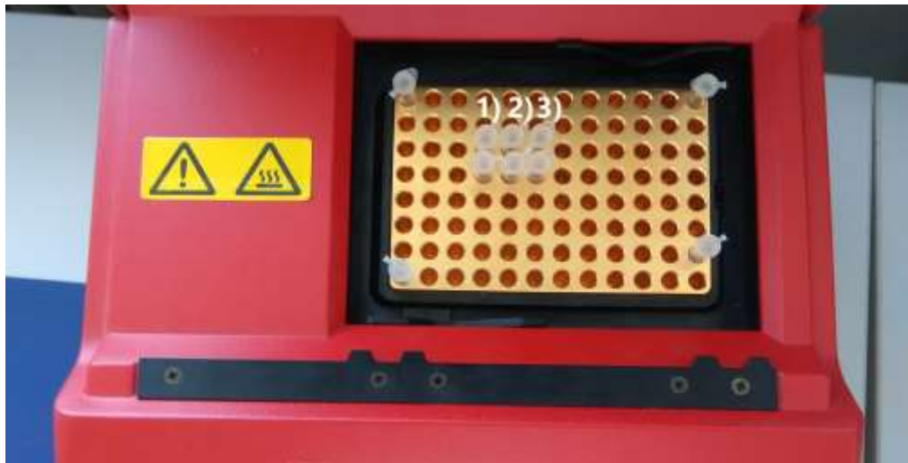
Abb. 9: Positionierung der PCR-Tubes (mit 100 \mu L Medium) im Thermocycler vor “Heat-Shock“. Spalte 1) enthält eine Bakteriensuspension mit einer OD_{600} 1,0; (2) eine OD_{600} 0,5 und (3) eine OD_{600} von 0,25. Der Heat-Shock fand wie oben beschrieben statt.
