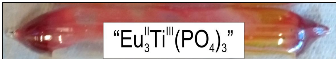
Abbildung 9.2: Roter Beschlag \{\text{P}_4(\text{g}) \rightleftharpoons 4 \text{P}(\text{s})\} in Kieselglasampulle nach Beendigung eines Experiments mit der Einwaage \text{Eu}^{\text{II}}_3\text{Ti}^{\text{III}}(\text{PO}_4)_3 (s. Exp. Nr. 1 in Tab. 12.1).
