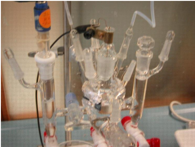
Abbildung 4-2: Fotografien der (A) „Impedanzzelle“ mit angeschmolzenem Glasrohr und Gegenelektrode (unten Mitte) und (B) der für die RRDE-Messungen verwendeten Zelle.
