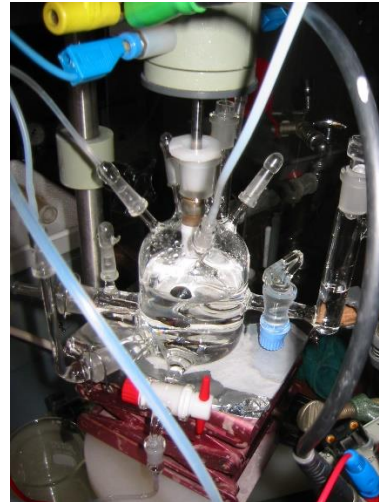
Abbildung 4-2: Fotografien der (A) „Impedanzzelle“ mit angeschmolzenem Glasrohr und Gegenelektrode (unten Mitte) und (B) der für die RRDE-Messungen verwendeten Zelle.
