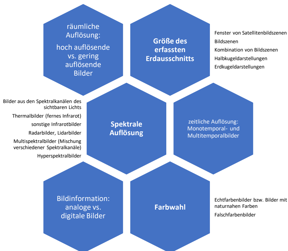
Abbildung 2.3: Technische Bildeigenschaften von Satellitenbildern, eigener Entwurf in Anlehnung an BREITBACH 1990, SEGER 2001, LEXIKON DER FERNERKUNDUNG 2020.
