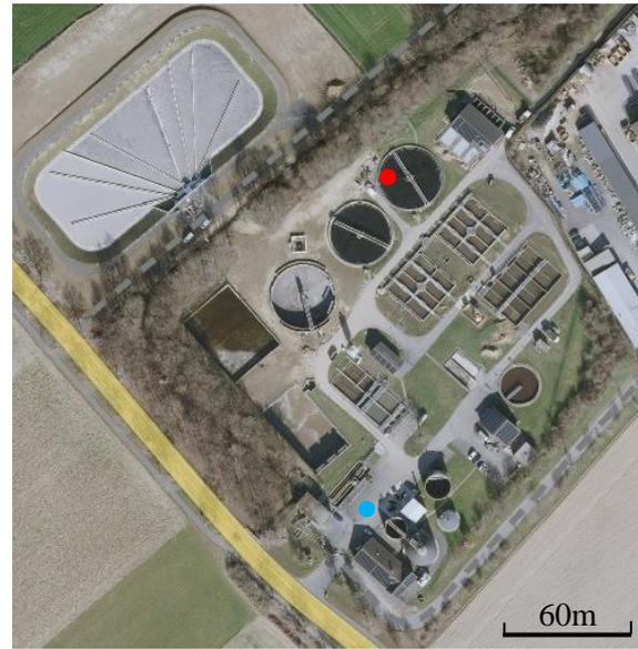
Abbildung 6: Kläranlage Rheinbach. Blauer Punkt: Probenahmegerät am Zulauf. Roter Punkt: Probenahmegerät am Ablauf. (GEOportal.NRW, 2021)
