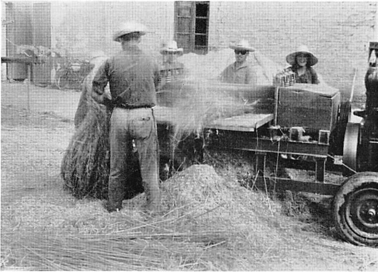
Bild 13: Mechanische Hanfbreche. Das Brechen der Hanfgerten wird in der Vega Baja del Segura mehr und mehr mit Maschinen durchgeführt.
