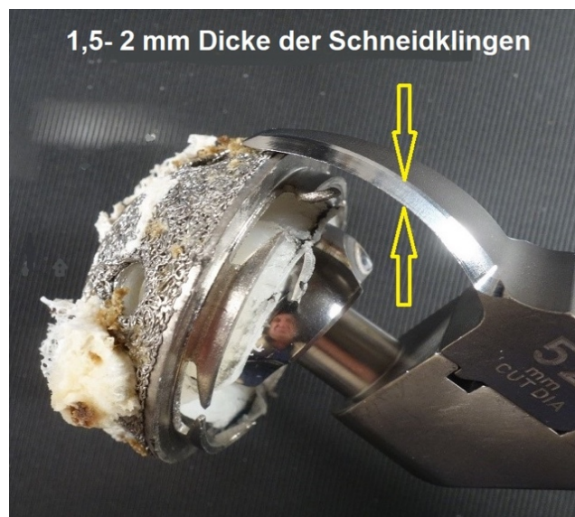
Abb. 87: Stark auftragende Schneidklinge des Zimmer Explant Acetabular Cup Removal Systems®
