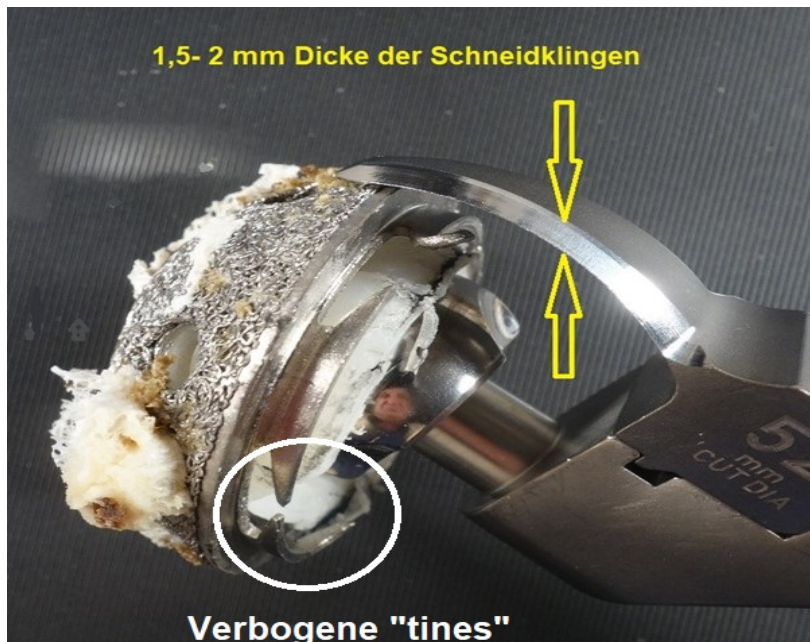
Abb. 16: Zimmer Explant Acetabular Cup Removal System® (Warschau, Indiana) Dieses System erfordert eine zentrale Führung durch ein exakt mittig zentriertes Probeinlay. Ein zerstörter Fixationsmechanismus (verbogene tines = Zähnchen) erschwert die Einpassung. Die Schneidklinge trägt mit 1,5 mm Dicke auf.
