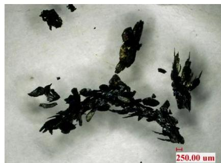
Abbildung 45: Mikroskopische Aufnahme der  $((\text{SMe})_2 \text{DTPy})_3[\text{Mo}_6\text{Cl}_{14}]$ - Kristalle.
