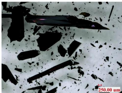
Abbildung 50: Mikroskopische Aufnahme der (N-Methylphenothiazin)<sub>2</sub>[Mo<sub>6</sub>Cl<sub>14</sub>]-Kristalle.
