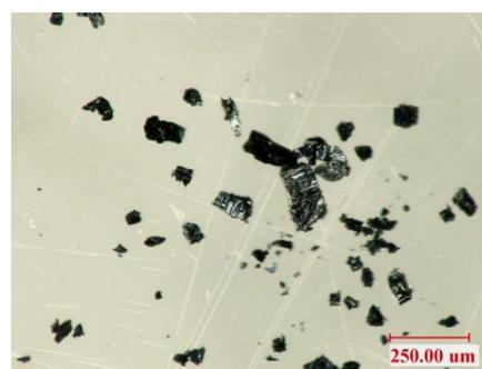
Abbildung 43: Mikroskopische Aufnahme der (SeA(OMe)<sub>4</sub>)<sub>2</sub>[Mo<sub>6</sub>Cl<sub>14</sub>]-Kristalle.
