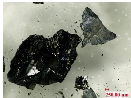
Abbildung 49: Mikroskopische Aufnahme der  $(\text{DBDAPMe})_3[\text{Mo}_6\text{Cl}_{14}]$ - Kristalle.
