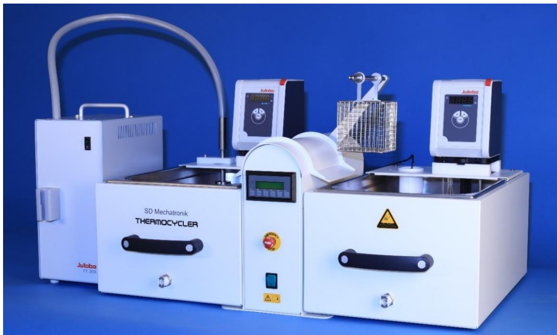
Abb. 3: Thermocycler der Firma SD-Mechatronik: zwei Wasserbecken unterschiedlicher Temperatur sowie ein Probenkorb, der je nach eingestelltem Zyklus zwischen den Becken abwechselt. Dieses Bild wurde freundlicherweise zur Verfügung gestellt von SD-Mechatronik.
