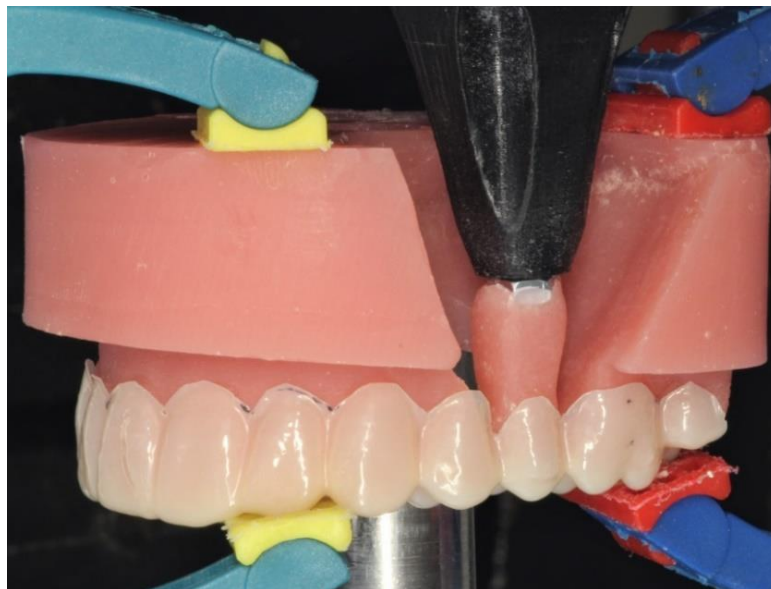
Abb. 7: Der zu untersuchende Zahn 25 in Neutralstellung im Zahnbogen. Der Aligner ist durch Klammern am Zahnbogen fixiert.
