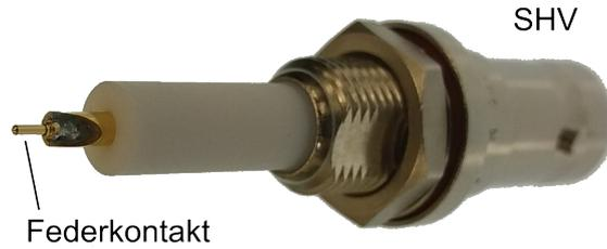
Abbildung 5.5.: Gasdichter SHV-Stecker mit angelötetem Federkontaktstift.
