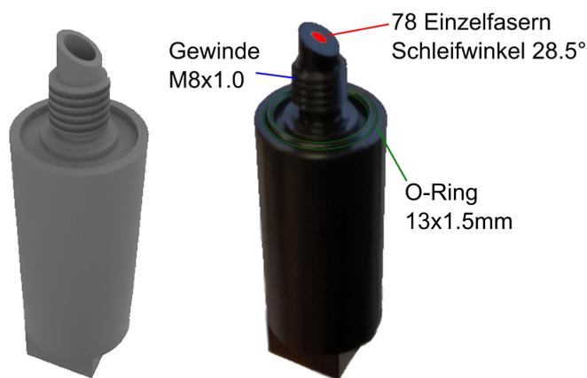
**Abbildung 6.9.:** CAD-Modell und Fotografie einer der acht Ferrulen, wobei der Schleifwinkel  $28.5^\circ$  beträgt. Die rote Markierung zeigt den Bereich der Fasern.
