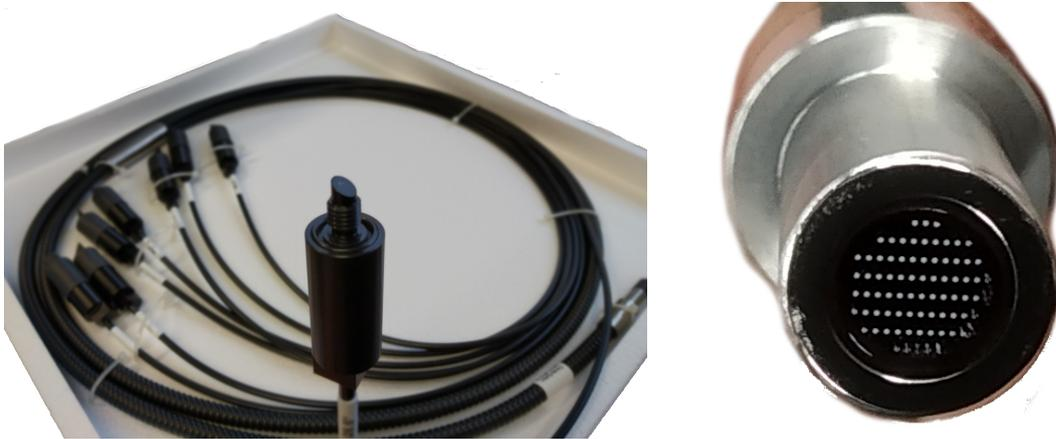
**Abbildung 4.6.:** Fotografie des Faserbündels (links) sowie des Faserbündeleingangs (rechts). In dem Bild leuchtet etwa ein Achtel aller vorhandenen Fasern.
